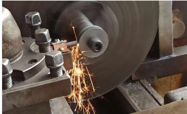
Рис.2. Реалізація способу зміцнення методом алюмотермії
