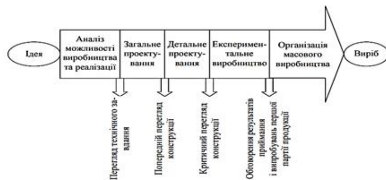
Рис. 1. Блок-схема послідовності розробки очисної системи
